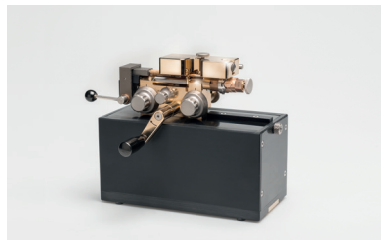
Machine à gratter les anches de hautbois
