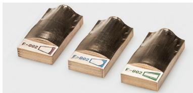
Le matrici vengono fabbricate in bronzo fosforoso per garantirne la durezza, sono perfettamente simmetriche e il loro spessore di riferimento è costante. Possono essere intercambiate facilmente nel giro di pochi secondi.
